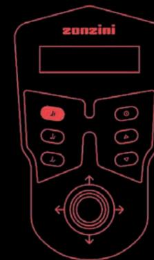
Posizionamento cingoli di massima chiusura. Pulsante in alto a sinistra del joystick. I cingoli si chiudono completamente e consentono alle ruote di appoggiare a terra, favorendo rotazioni su scale strette e gradini a piede d'oca.
