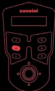
Posizionamento cingoli in posizione intermedia. Pulsante in mezzo a sinistra del joystick. È possibile salire e scendere il gradino sfruttando la coppia di denti dei cingoli in presa sul gradino. Questa è la modalità di utilizzo "gradino per gradino", in cui l'operatore deve gestire il bilanciamento del carico.
